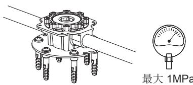
将冷热水管道加压到1MPa，检查有无渗漏。
