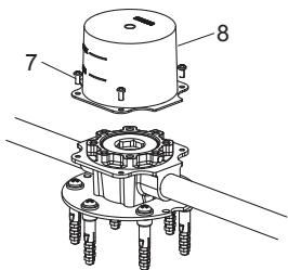
用螺钉(7)将保护罩(8)固定到底座。
