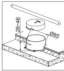
保护罩底面到地砖上面的距离控制在26~46mm之间(地砖上面位于保护罩的MIN和MAX线之间)。在地砖上钻Ø85的孔，铺装地砖。安装水龙头前用锯条贴地砖表面锯除保护罩露出部分。水龙头的安装请参考对应的产品说明书。
