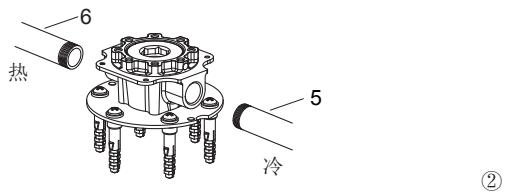
螺纹处须缠绕足以密封的密封胶带或适合的密封胶，将冷热水管(5, 6)旋入底座。**注意：**带有蓝色标记的一端接冷水。如因管道安装破坏了底座的水平状态，要重新进行调整。
